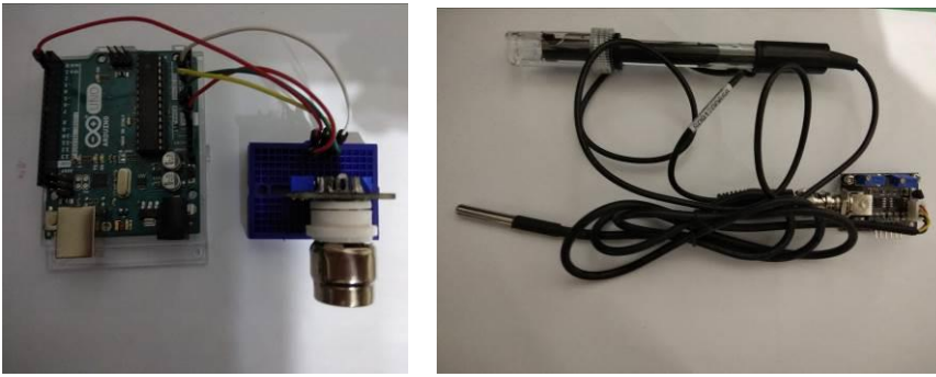
圖 10 本研究所使用之 Arduino®晶片。(左)CO 2 偵測模組；(中)酸鹼值偵測
