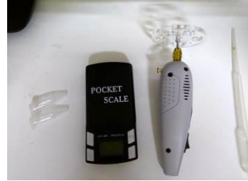
離心管(左)，電子秤(中)，自製離心機(右)
