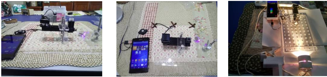
圖 7 模組化的手機光譜儀。螢光手機光譜儀側視圖 (左)；俯視圖(中)；可見光模組(右)
