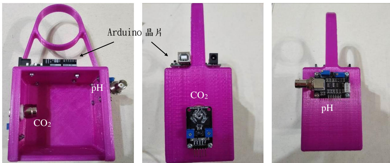
圖 26 檢測盒成品圖。俯視圖(左)；側視圖(中，二氧化碳模組)；側視圖(右，pH 模組)
