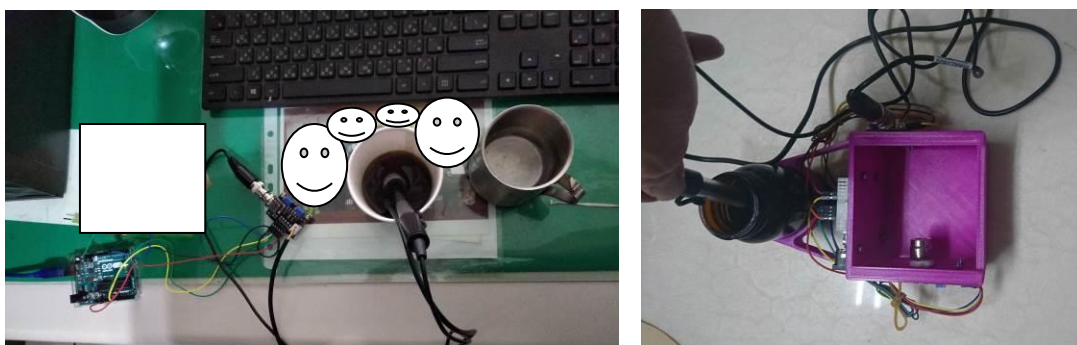
圖 9 咖啡酸鹼值測定器(右)；pH 偵測盒量測情況
