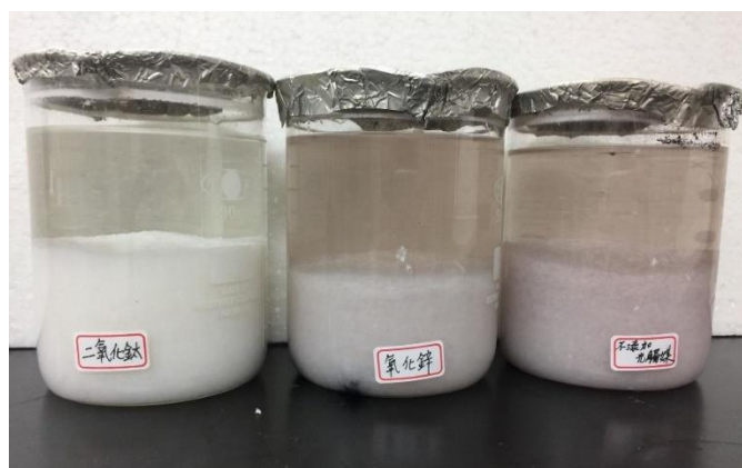
圖 15. 以紙漿加入光觸媒照 UV-A 後降解之結果
