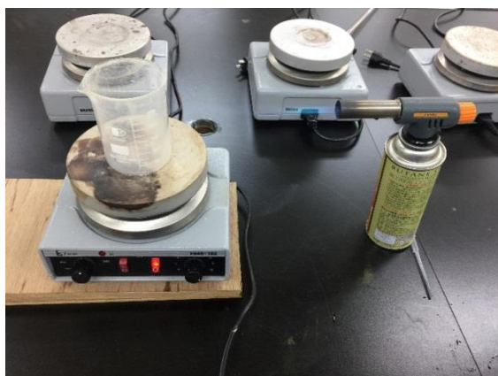
圖 16. 以特製的磁石攪拌器搭配噴槍使燒杯穩定加熱
