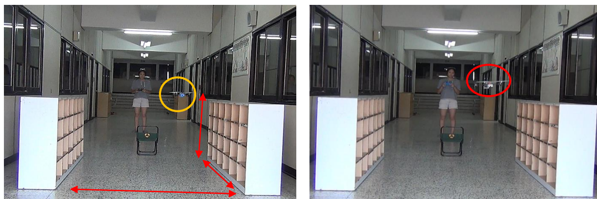
圖 19、固定無人機飛行高度與範圍搭載 MQ3、DHT11 感測器，紀錄飛行時間
