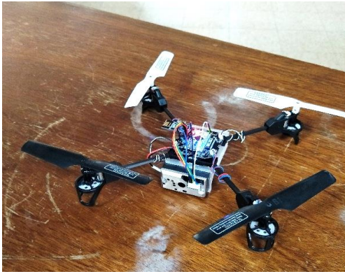
圖 28、機翼可拆下重複利用
