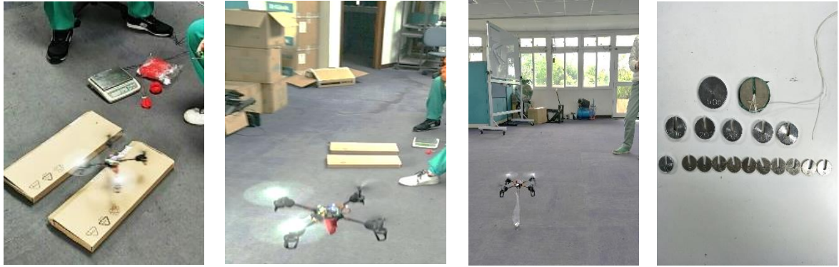
圖 6、利用砝碼，紙黏土找出最大載重測試圖(最右圖為 95 公克)
