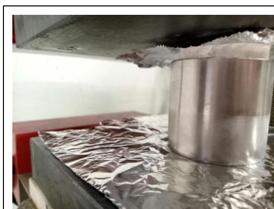
圖二十四：實驗三成品抗壓能力測試
