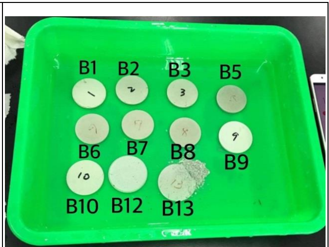
圖十七：實驗二成品之吸水度測試(第 5 分鐘)
