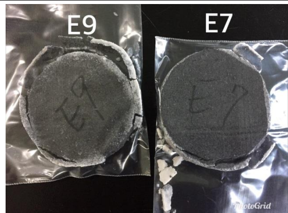
圖二十一：編號 E7、E9 泡水 24 小時後之狀態
