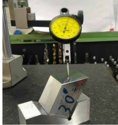
圖 13 量表檢驗角度塊是否水平
