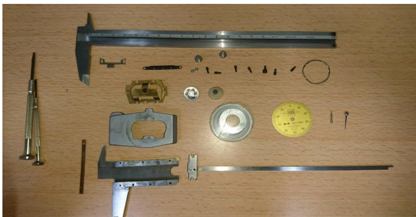
圖 5 TESA 游標卡尺拆解圖
