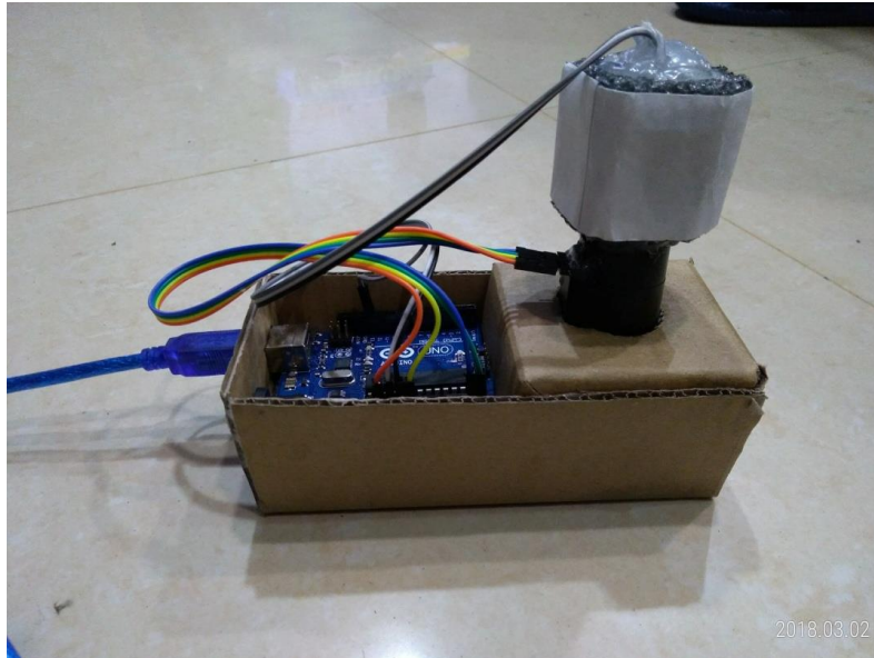
▲圖 10 自製紅光雷射 Arduino 快篩儀
