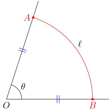
**主要定理 5.** 給定一條長度為  $\ell$  的繩子，在邊界為平滑曲線的凸形區域內，圍出一塊區域。此圍出區域最大面積發生在「以繩子兩端與平滑曲線接點處為切點的兩條切線之交點為圓心，此交點到接點的長度為半徑，所畫出的圓弧上」，如下圖。
