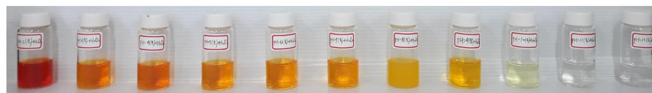
【圖】檸檬酸鈦前驅物在不同 \text{pH} 的沉澱後的濾液加入 4 M 強鹼 5 滴-拍照狀況
