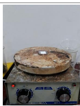
步驟 12-2-4 使用磁石加熱攪拌機充分加熱
