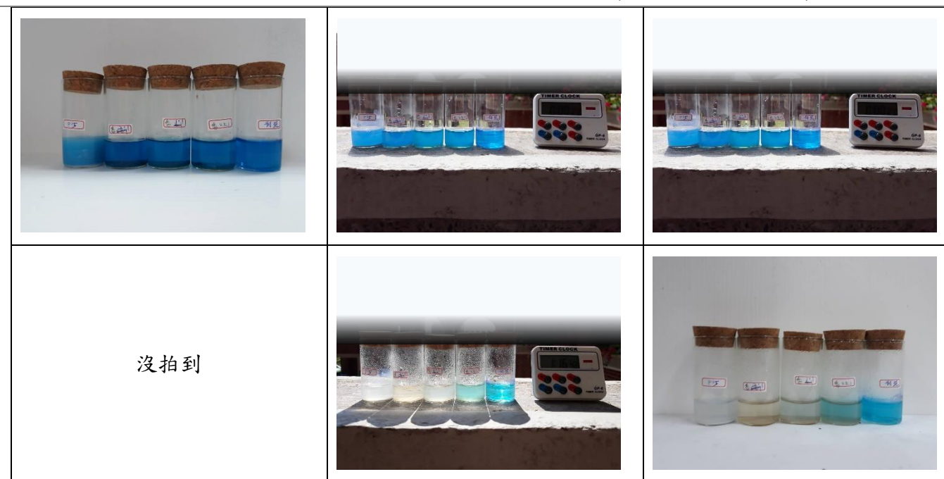
【圖】不同煅燒溫度處理的 TiO 2 催化亞甲藍液褪色的實驗過程
