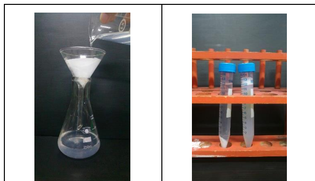
【圖】左為過濾時，膠體透過濾紙的情形 右為離心前後的膠體沉降情形
