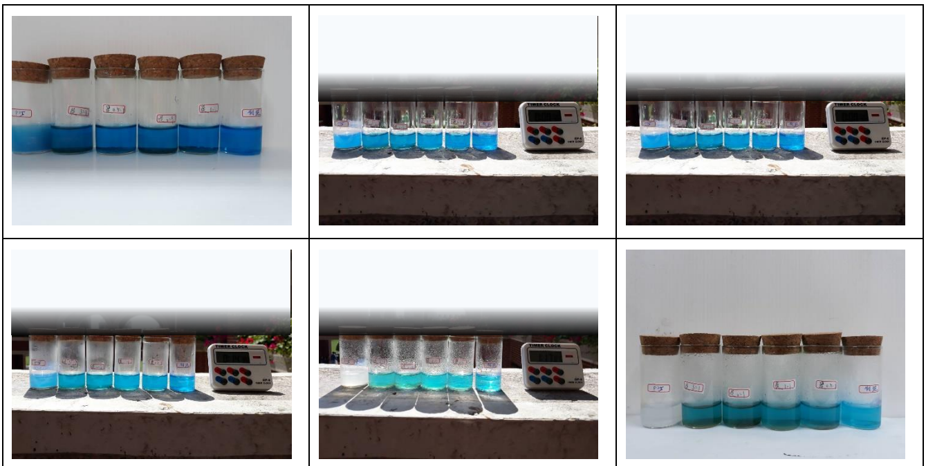
【圖】 活性碳/Ti(cit) 經調整至 pH11 並煅燒 700°C 之 TiO 2 催化亞甲藍的降解曲線 (TiO 2 =0.030 g)
