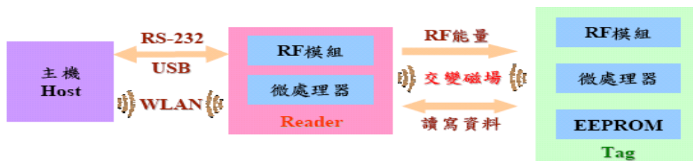
圖 2 RFID 動作原理(資料來源： http://GRC.yzu.edu.tw/ )
