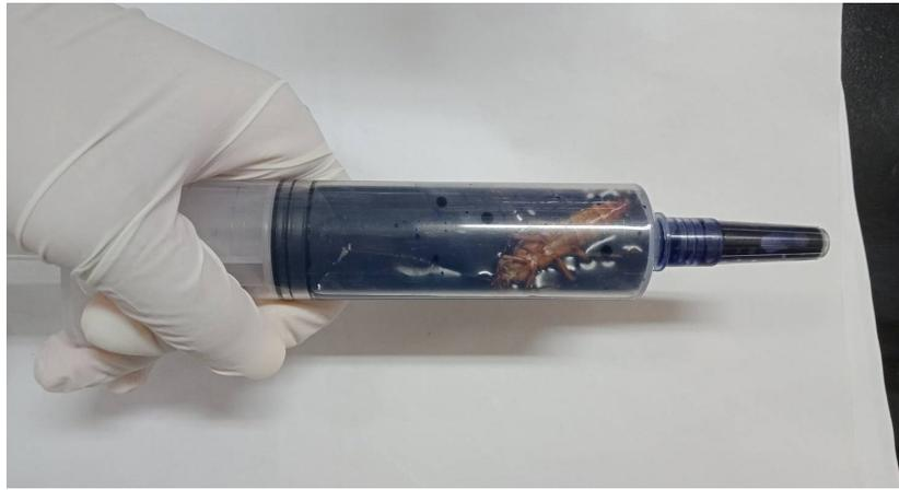
圖六 利用負壓環境中蟑螂氣管系統攝入亞甲藍液的程度，比較氣道閉鎖程度的裝置照片。
