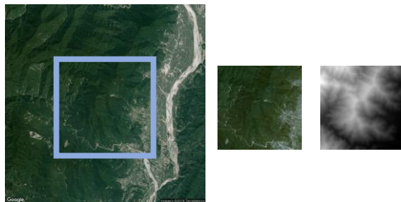
圖九、API 回傳之空照圖、裁切後的空照圖及該位置的高度圖
