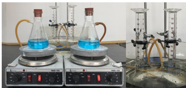
圖 10 排水集氣法收集氫氣 H_2 (步驟 1、2 及 4)
