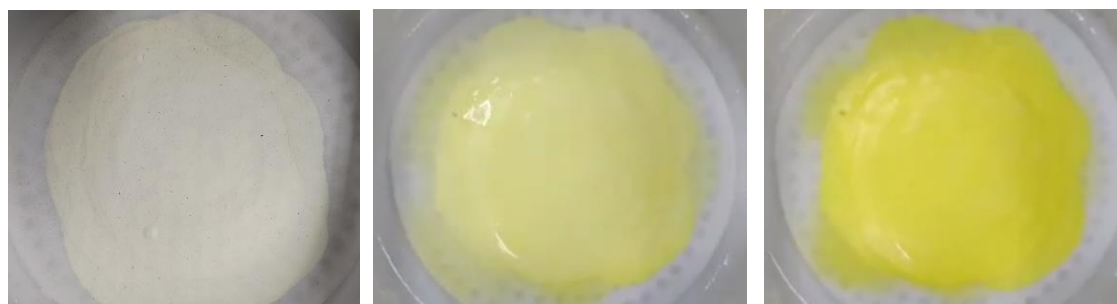
圖 3-5-1a：硫酸銅限量的產物水洗顏色轉變過程（由左至右）
