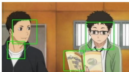
圖 29 以 OpenCV 內件工具偵測臉部的結果舉例
