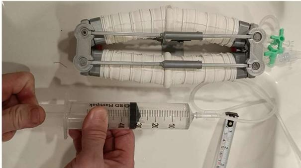
兩個保衛細胞模形置於骨架中，以手動推壓針筒，模擬膨壓增加，量尺測量張開寬度
