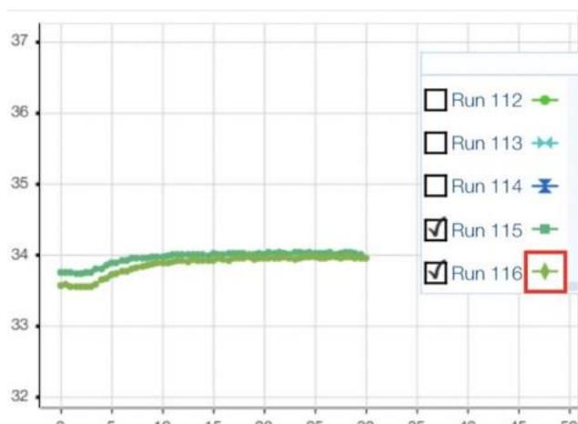
圖 30：乙醇與異丙醇混合時的溫度變化（大約 0.5 度）
