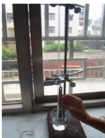
照片三：將已降解後的幾丁質溶液裝管以進行分子量之測定
