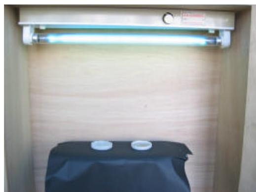
照片四：在紫外光的照射下，以分別燒結奈米級及試藥級二氧化鈦的石英玻璃皿裝幾丁質以進行降解
