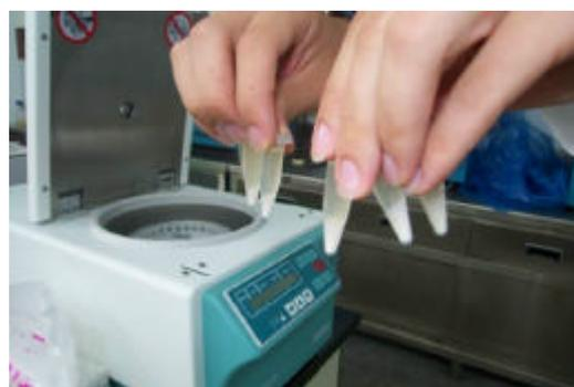
照片二：利用高速離心機分離奈米級 TiO<sub>2</sub> 與幾丁質溶液
