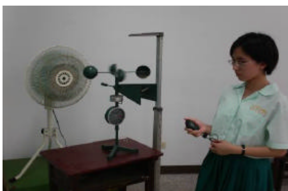
圖版三 以風速計測量風扇的風速
