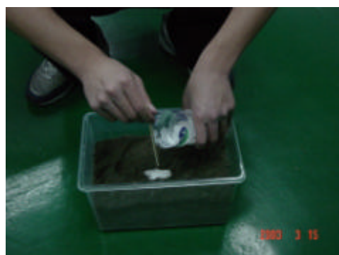
圖五 不定時加入石膏（因為石膏內有空氣，所灌石膏會一直下陷）
