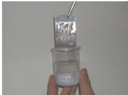
圖 16 未經修飾的鐵片浸泡 3 % \text{NaCl}_{(\text{aq})} 二週後，鏽蝕嚴重，且有剝落現象發生。
