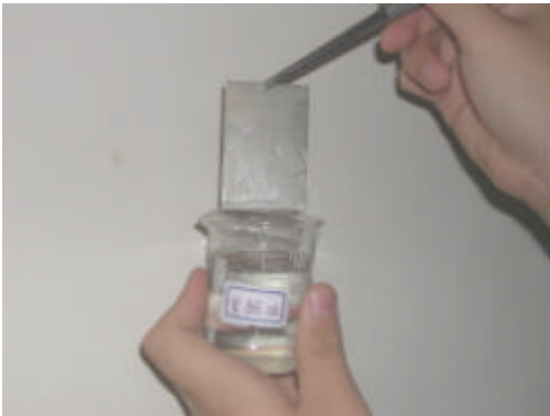
圖 13 以聚苯胺修飾的鐵片浸泡 3 % \text{NaCl}_{(\text{aq})} 一週後，仍無鏽蝕。
