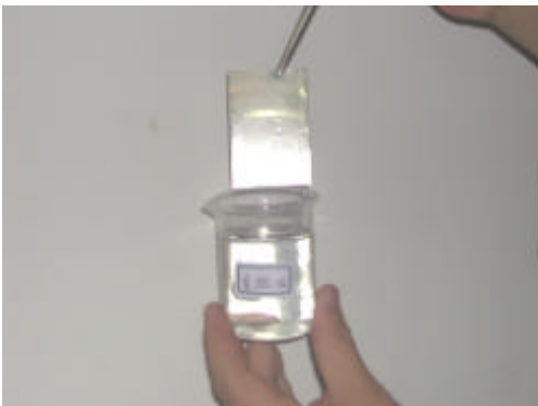
圖 15 以聚苯胺修飾的鐵片浸泡 3 % \text{NaCl}_{(\text{aq})} 二週後，仍無鏽蝕。
