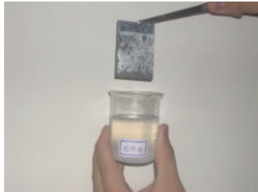
圖 14 未經修飾的鐵片浸泡 3 % \text{NaCl}_{(\text{aq})} 一週後，鏽斑增加許多。
