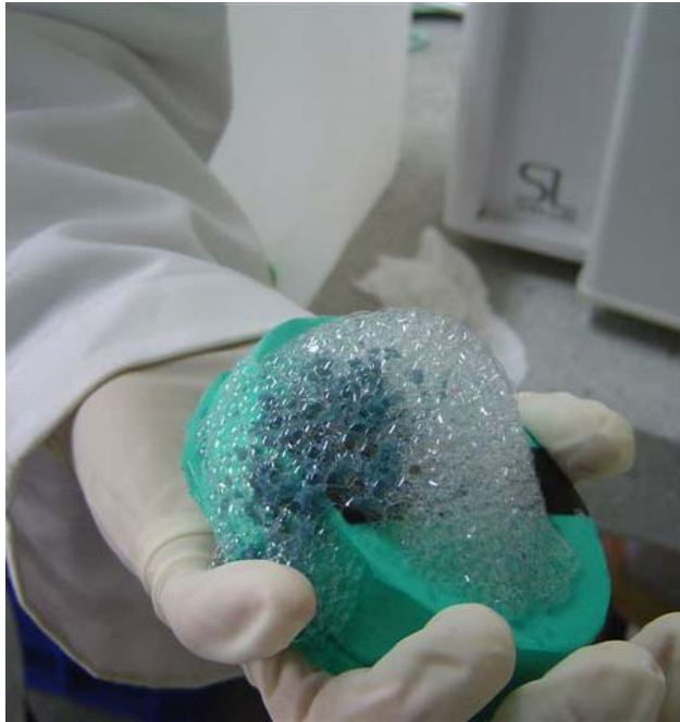
圖二十四 浮選後被泡沫帶出的含鉻化合物 圖二十五 去掉泡沫的含鉻化合物
