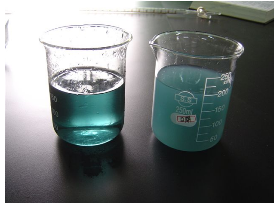
圖十九 白蘭組的浮選過程 圖二十 白蘭組浮選前後(左邊較清澈者為浮選後溶液)
