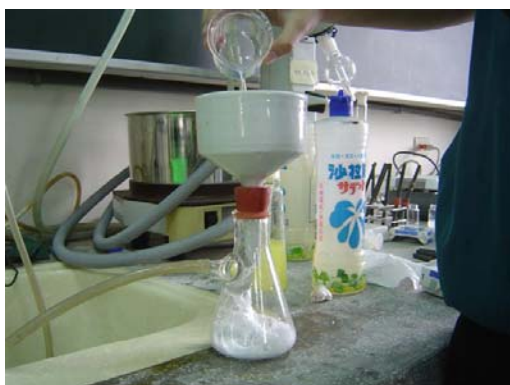
圖十二 抽濾溶有碳酸鈉的浮選溶液
