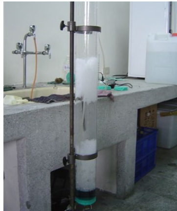
圖十九 白蘭組的浮選過程 圖二十 白蘭組浮選前後(左邊較清澈者為浮選後溶液)
