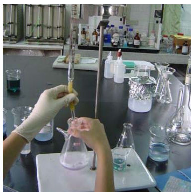
圖十三 以 \text{NaOH}_{(\text{aq})} 滴定
