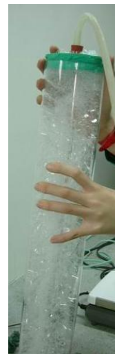
圖十 利用浮選裝置四進行浮選操作
