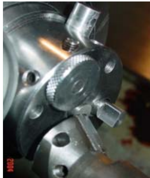
圖 18、內徑刀 Z 軸校刀
