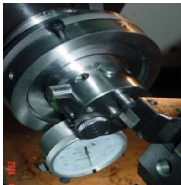
圖 14、M/C 銑床刀長校刀驗證
