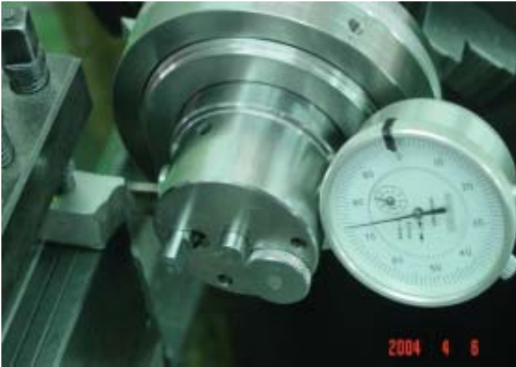
圖 22、傳統車床校刀實驗
