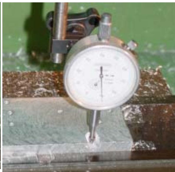
圖 14、M/C 銑床刀長校刀驗證
