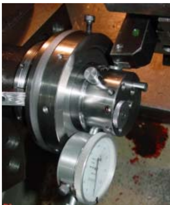
圖 15、CNC 車床外徑刀校刀
