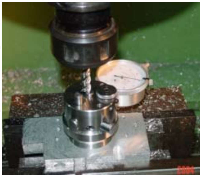
圖 13、M/C 銑床刀長校刀
