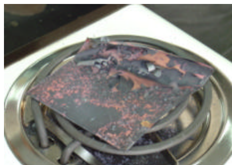
圖十六 燒結式光電池單晶面積(粉紅色部分)平均可達 1 \times 1\text{ cm}^2
