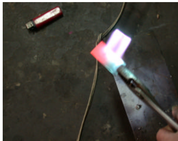
圖四 氫氧焰熔燒法製作氧化亞銅
