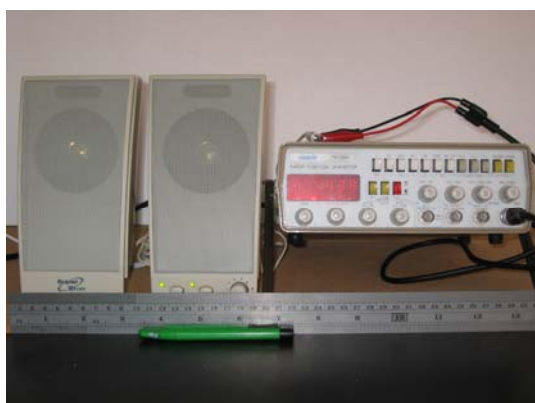
彩圖七、訊號產生器連接喇叭
