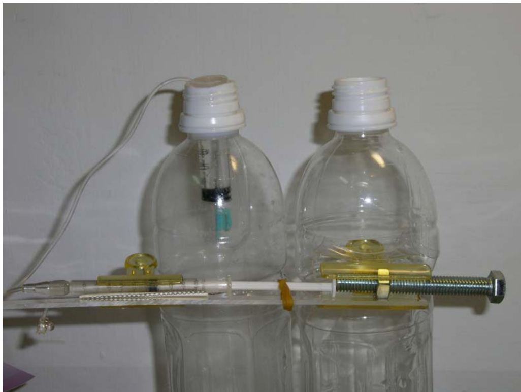
以螺絲為推進器，可更有效的控制油滴大小，使數據更為精確。
