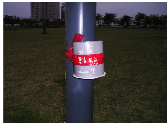
圖八 自製之沙塵收集筒
