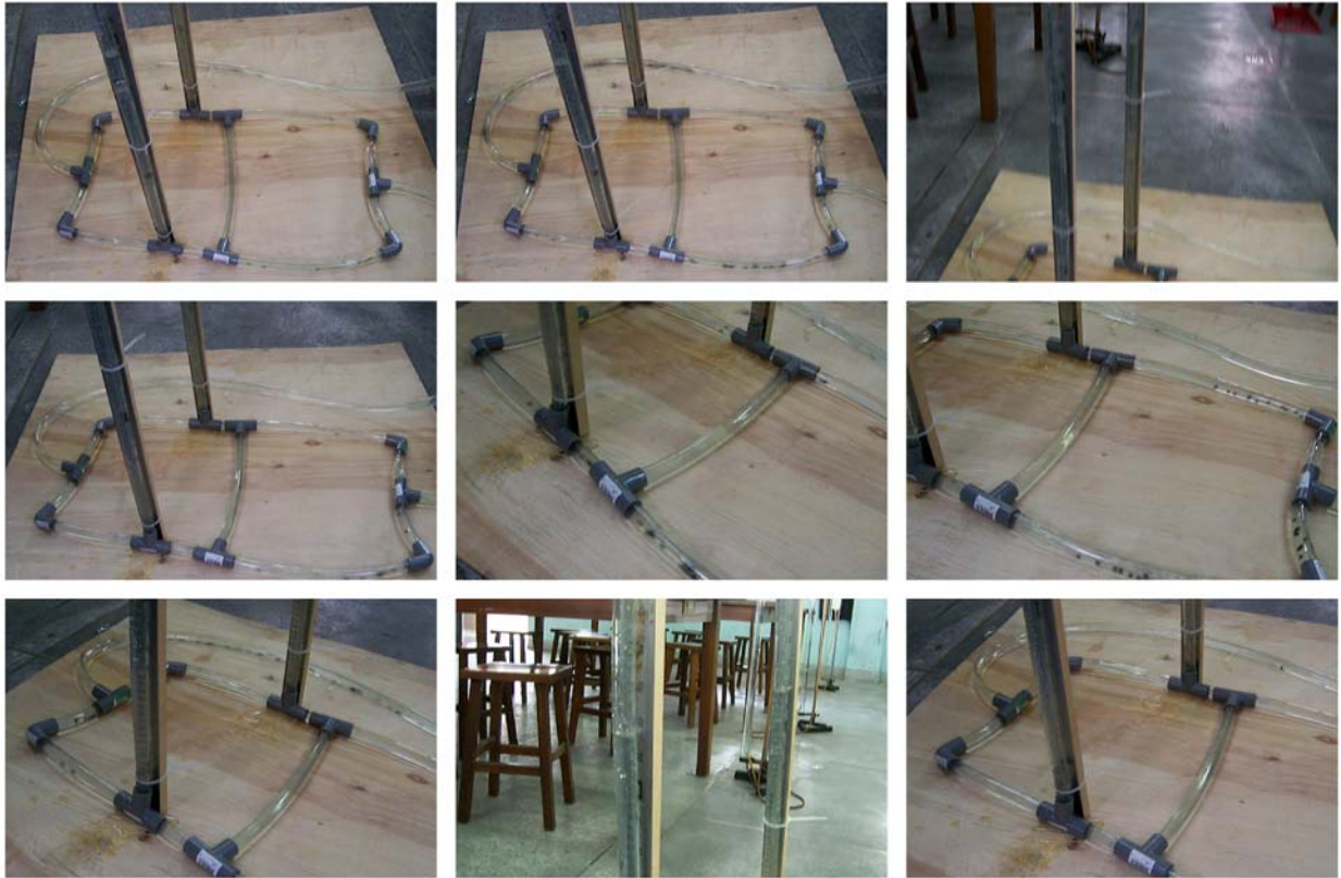
惠斯同電路模擬在運作中可明顯看出中間的管線內部完全沒有小黑珠通過；但若將其一個管線改變長度有較大差異或明顯的粗細不同則可看出其中的管線會有小黑珠通過。
