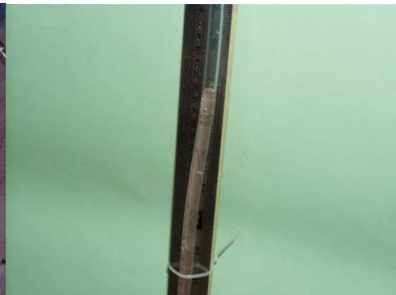
小黑珠流動及透明支管處可由水面高度來觀察水壓大小
