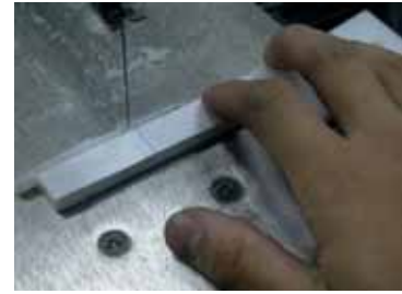
圖 18 線鋸機切割 PE 板
