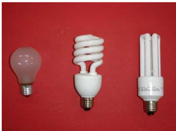
圖七 實驗用各種燈泡實體圖(由左至右分別是鎢絲燈、螺旋與 3U 燈泡)
