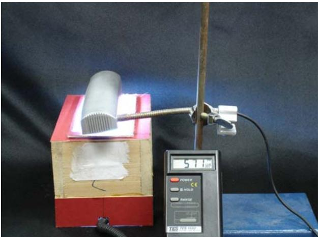
附圖五 濾網過濾效果測試裝置
