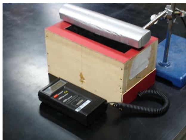
圖十 濾網過濾性能檢測裝置實體照片
