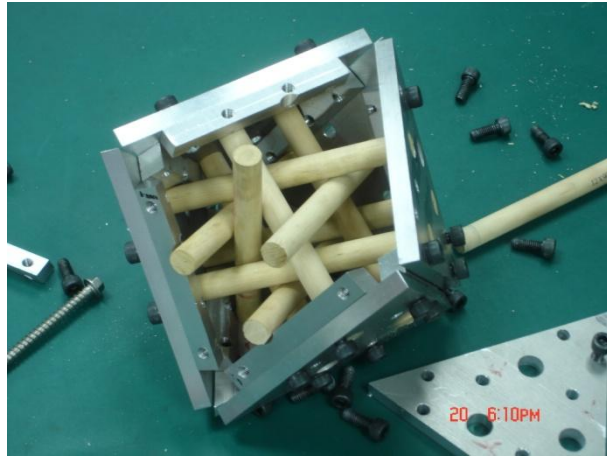
圖 51 菱形十二面體模具(拆開兩片定位板，查看內部細節)
