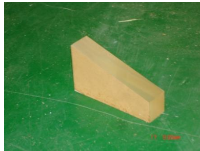
圖 45 角度規：用銑刀切割後為角度規
