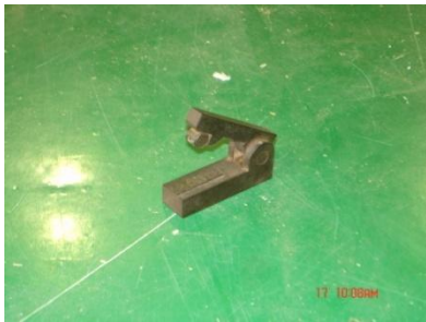
圖 44 正弦桿：先將所需使用的角度用正弦桿擺好，接著將壓克力板放在調整好角度的正弦桿
