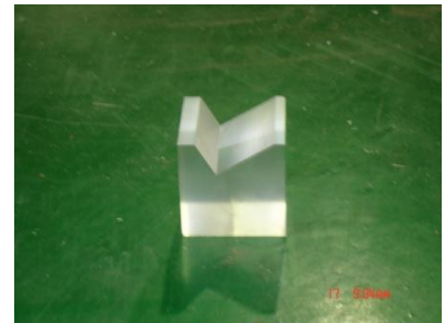
圖 46 V 型枕：將角度規作為底座，在將另一個壓克力板放在與角度規的平行斜面上用虎鉗固定，再進行銑割，夾具 V 型枕完成
