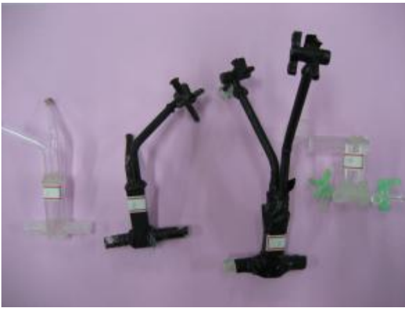
圖十五 自製振盪偵測儀的改良(由左而右)
