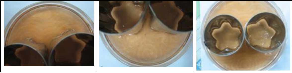
圖十一 磁鐵在兩邊時,振盪圖形隨時間變化之流程
