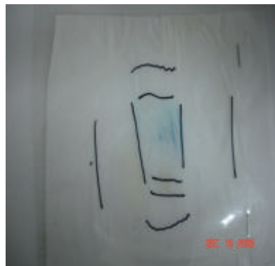
圖十一 B 利用 CMC 凝膠薄膜(未加入 \text{TiO}_2 )照射紫外光，光阻液並未明顯變淡
