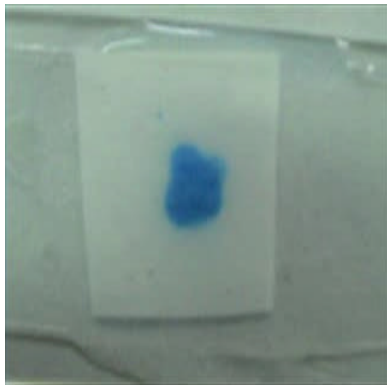
圖十一 B 利用 CMC 凝膠薄膜(未加入 \text{TiO}_2 )照射紫外光，光阻液並未明顯變淡
