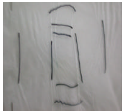
圖十一 B 利用 CMC 凝膠薄膜(未加入 \text{TiO}_2 )照射紫外光，光阻液並未明顯變淡
