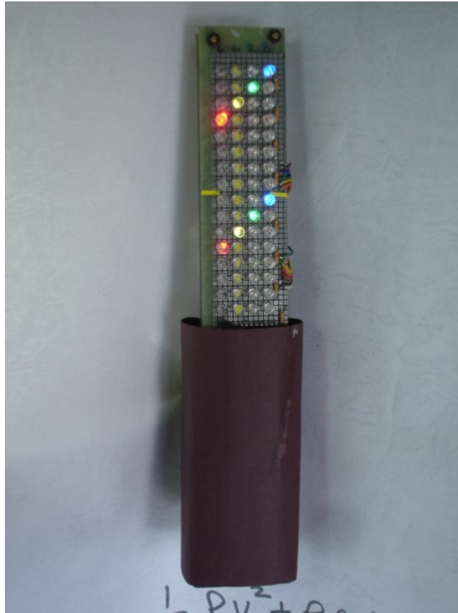
圖十二、組合在一起的照片，6 顆 3 號電池裝在下方握把中。
