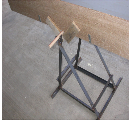
照片 7 實驗槽置於三角架上
