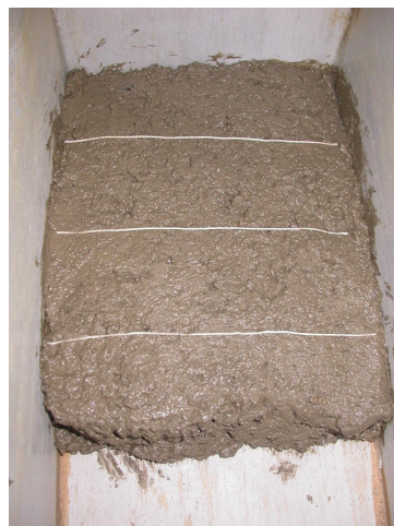
照片 9 實驗前在土石上放置三條平行棉線
