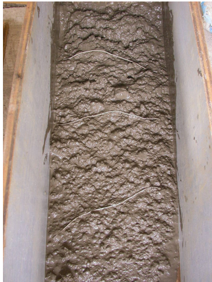
照片 11 土石運動後三條線發生彎曲則為流動
