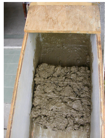
照片 10 土石運動後三條線仍維持平行則為滑動
