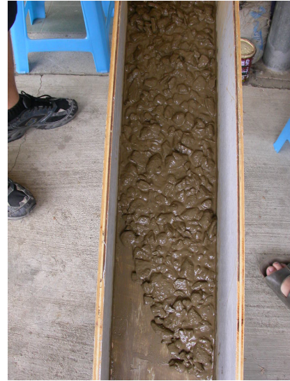
照片 4 抽起擋板，土石向下流動
