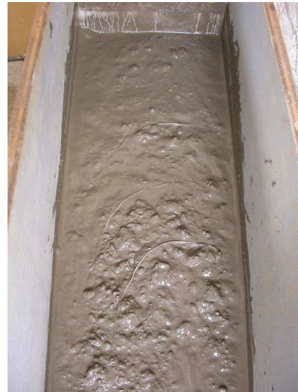
照片 12 土石運動後三條線發生彎曲則為流動
