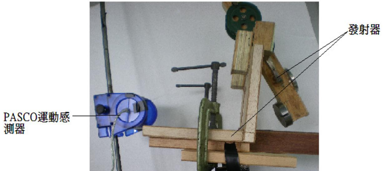
我們將木板釘成 L 型並在上方架設可動式槓桿，槓桿前端黏有重物，以 C 型夾固定在軌道上方，讓軌道與發射器平行。並在發射器中央挖出一個邊長 0.08m 的正方形，此發射器的應用原理為木板和槓桿上的重物可夾住水罐並自由釋放，當我們在很短的時間內拉起槓桿便可釋放水罐。此發射器的優點有：
