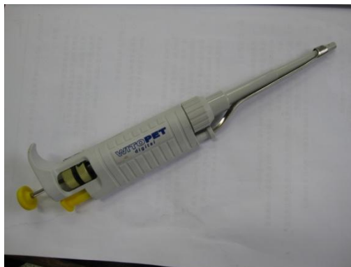
微量吸取器( 20\mu\text{L}\sim 200\mu\text{L} )
