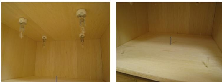
圖 ( 9 ) 第一階段模型的加熱燈與感溫線
