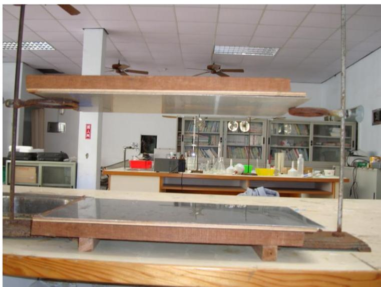
圖二 自製平行電板
