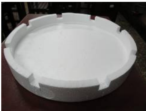
圖 8-17 每個開孔夾角必須為 45 度
