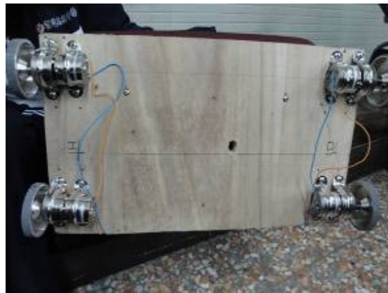
圖 10-2 由四個直流減速馬達構成行李箱的動力
