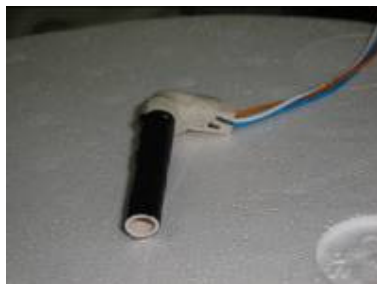
圖 8-9 利用筆管限制接收角度
