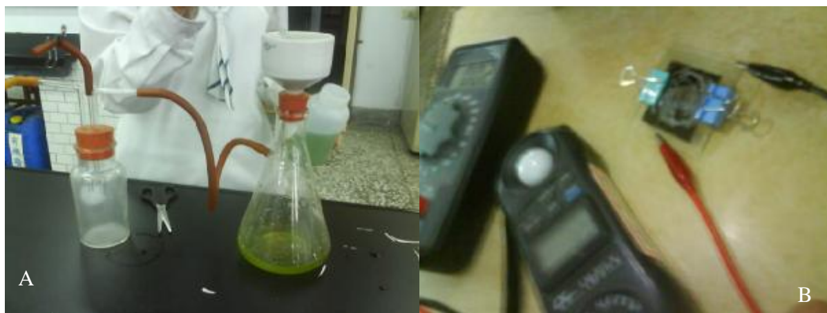
圖一 海藻萃取裝置(A)光度計和三用電錶測定電壓裝置圖(B)
