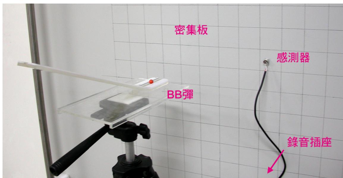
圖 7 感測器聲波記錄測試裝置
