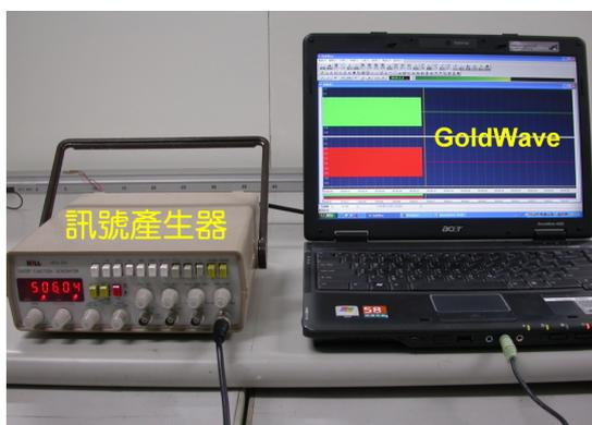
圖 2-1 訊號產生器輸出訊號至音效卡
