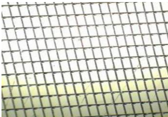
圖 21. 導電玻璃(白) 已刮顯微照(40 X)
