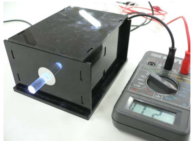
圖 13、光敏電阻實驗架構
