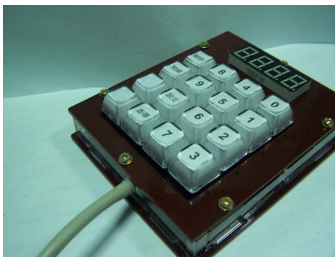
圖 33 七段顯示器以及輸入元件實作圖
