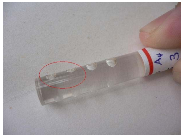
圖 37 第二孔較淺加工
