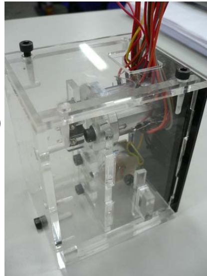
圖 35 開關電路測試實做圖
