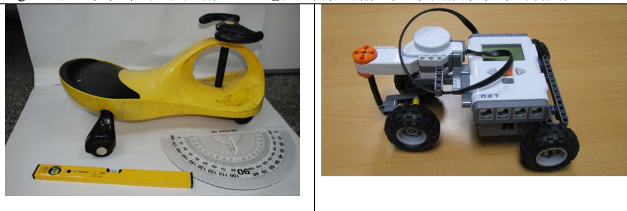
Fig.01：大型扭扭車（左圖，耐重 120 kg），自製可輸入程式的動力扭扭車（右圖）
