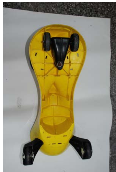
Fig.03：扭扭車「後退」底面圖（右圖），轉動軸 K 位於前輪與後輪之間，等效車身 MP 增加，容易大角度後退。
