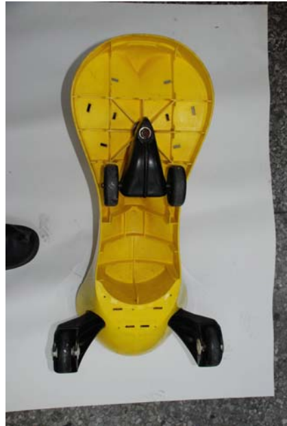
Fig.03：扭扭車「後退」底面圖（右圖），轉動軸 K 位於前輪與後輪之間，等效車身 MP 增加，容易大角度後退。
