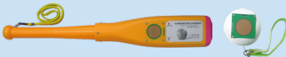
應用觸控感測與慣性感測單元的無線棒球遊戲裝置成品
