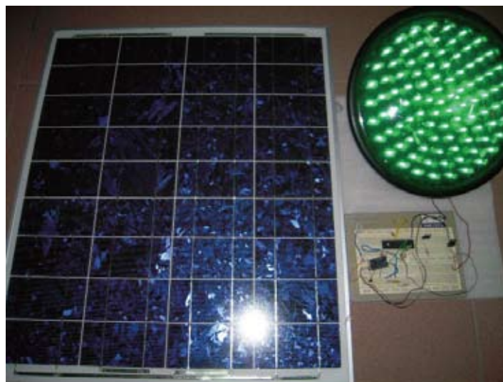
以強光投射燈源模擬太陽照射太陽能電池作為供電電源情況下，實體電路工作情形
