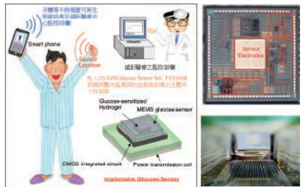
圖1 > 植入式CMOS連續血糖監測 System on Chip
