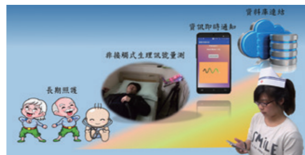
圖 1. 利用這套系統，可以在不接觸人體的情況下，偵測人體心率與活動程度。並搭配手機 App，將所偵測得資訊即時通知給相關照護人員，達到舒適與長期照護的目的
