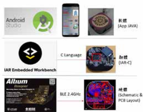
圖 1. 群組化多裝置防遺失警報器之軟_韌_硬體設計架構
