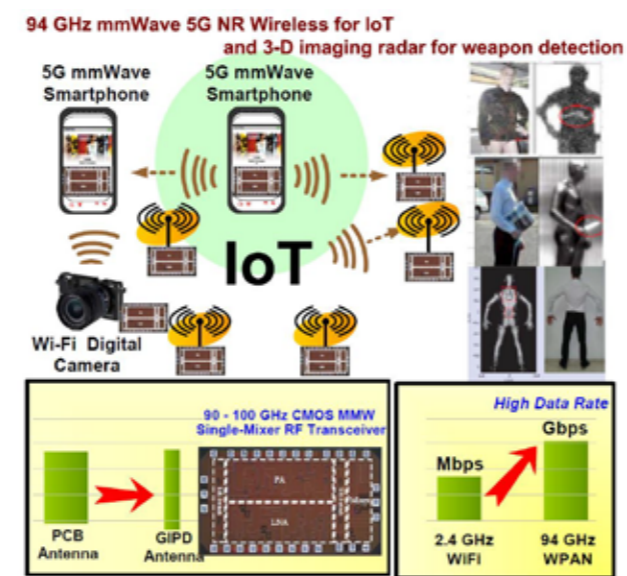
圖 2. 90-100 GHz CMOS 單混頻器射頻收發機毫米波晶片圖。本毫米波射頻前端晶片，未來可用於 5G NR 94-GHz 毫米波通訊及 IoT 的應用，另外還有應用於 94-GHz 毫米波 3-D 影像雷達來偵測隱藏在人體的武器
